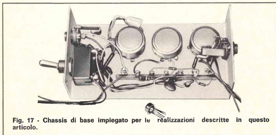
Fig. 17 - Chassis di base impiegato per le realizzazioni descritte in questo articolo.
