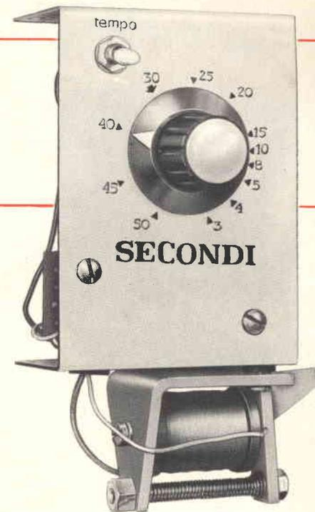
Quest'ultimo, in tal modo, è portato istantaneamente in un regime di conduzione. Uno SCR «chiuso» è uguale ad un interruttore parimenti chiuso, quindi, essendo SCR innescato, tutta la tensione della pila «B» si presenta ai capi del solenoide «SOL» chiudendolo. Per ottenere la caduta del «SOL» è necessario aprire S1, e da questo momento in poi il circuito è pronto ad un nuovo ciclo di operazioni.
